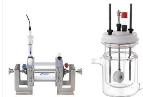
การติดตั้งอุปกรณ์ทดสอบการกัดกร่อนตามมาตรฐาน ASTM G 5
